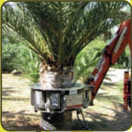
**ECOPALM Ring** è una macchina a **FASCIA CIRCOLARE**, dotata di generatori elettrici di microonde che irradiano l'energia ad altissima frequenza verso il centro della palma. La macchina è dotata di settori che si **APRONO** e **CHIUDONO** elettricamente per l'inserimento della palma da trattare dentro la fascia circolare.
